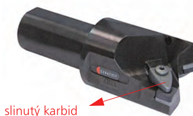
Obr. 5: Nástroj s upínacím prvkem ze slinutého karbidu.
