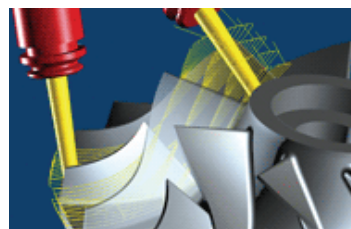
Obr. 7: Souvislé pětiosé hrubování
