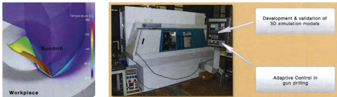
Obr. 5: Simulační model vrtání a jeho aplikace při adaptivním řízení vrtání
