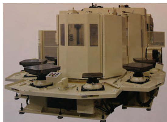
Obr. 20: YASDA - YBM 7T s výměnou palet PLS
