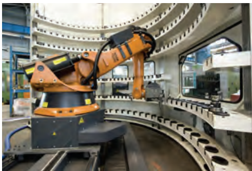
Obr. 5: Výměna nástrojů u stroje firmy Pama Obr. 6: Systém AVN Tool Arena firmy Demmeler při výměně nástroje v horizontální a vertikální poloze
