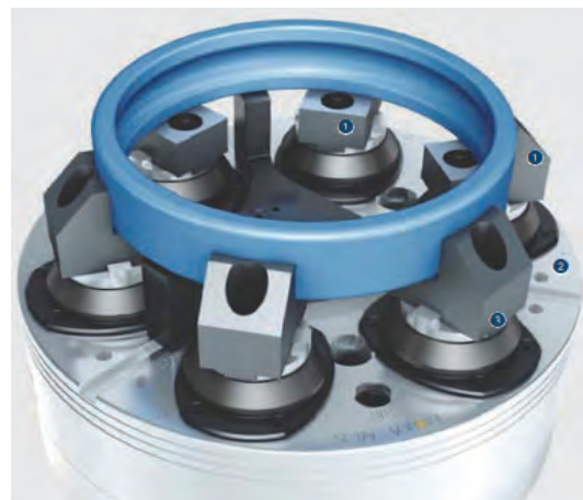
Obr. 11: 6tičelist'ová upínací univerzální hlava firmy SHUNK pro upínání tenkostěnných obrobků
