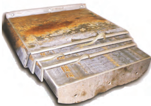
Obr. 7: Opotřebovaný kryt a nově vymodelovaný kryt
