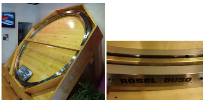
Obr. 11: Velkopřůměrové válečkové axiální ložisko RÖSSL&DUSO
