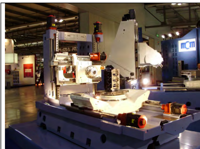
Obr.5 Čtyřosé horizontální centrum MCM
