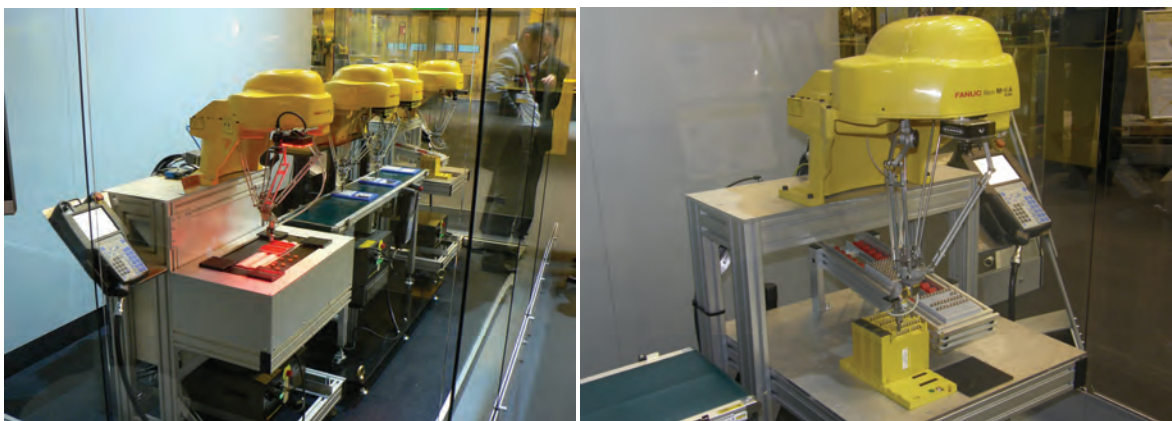
Obr. 9: Robot Fanuc M-1iA/0.5A s paralelní kinematickou strukturou
