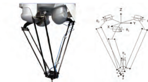
Obr. 2: Schéma paralelní kinematické struktury
