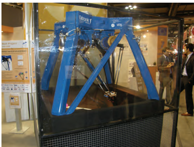
Obr. 11: Vysokodynamický manipulátor Fatronik vyvinutý v rámci evropského projektu Next
