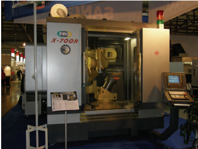
Obr. 6: Obráběcí centrum Leadwell X-700R s paralelní kinematickou strukturou
