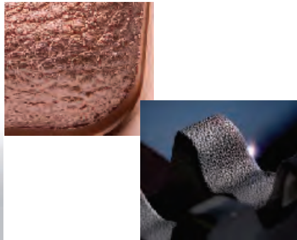
Obr. 7: +GF+ laserem texturovaný povrch
