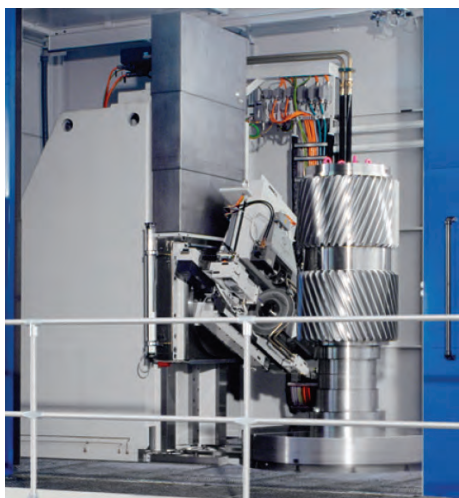
Obr. 4: Gleason - Pfauter 2000G, bruska na profilové broušení ozubení, Rz lepší 1,5 \mu m, Ra lepší než 0,2 \mu m
