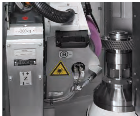
Obr. 8: Vlevo: Princip broušení ozubení systémem Reishauer, široký, profilový kotouč
