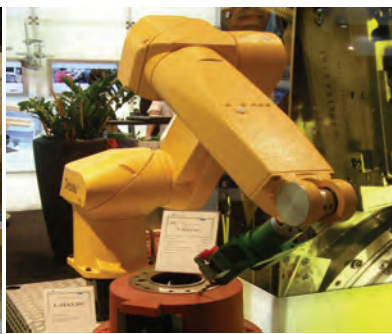
Obr. 2: Aplikace vrtací jednotky SUHNER s robotem STÄUBLI
