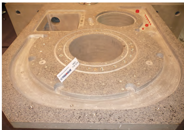
Obr. 5: Cementové betonové lože stroje POWERTURN
